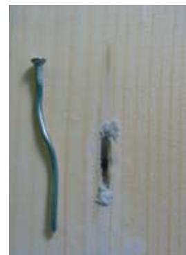
Plastische Verformung und Lochaufweitung nach der zyklisch-dynamischen Beanspruchung der Konstruktion. FERMACELL Gipsfaser-Platten (oben), Holzunterkonstruktion (rechts), Verbindungsmittel (unten).
